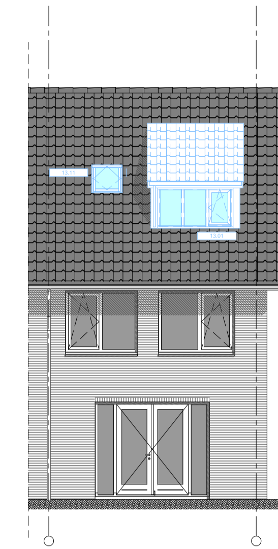
ACHTERGEVEL 13.01 dakkapel, breedte +/- 1,94 mtr (binnenmaat) oppervlakte uitbreiding 1,5 m² 13.11 dakraam type Velux GGL-MK04 ca.78x98cm
